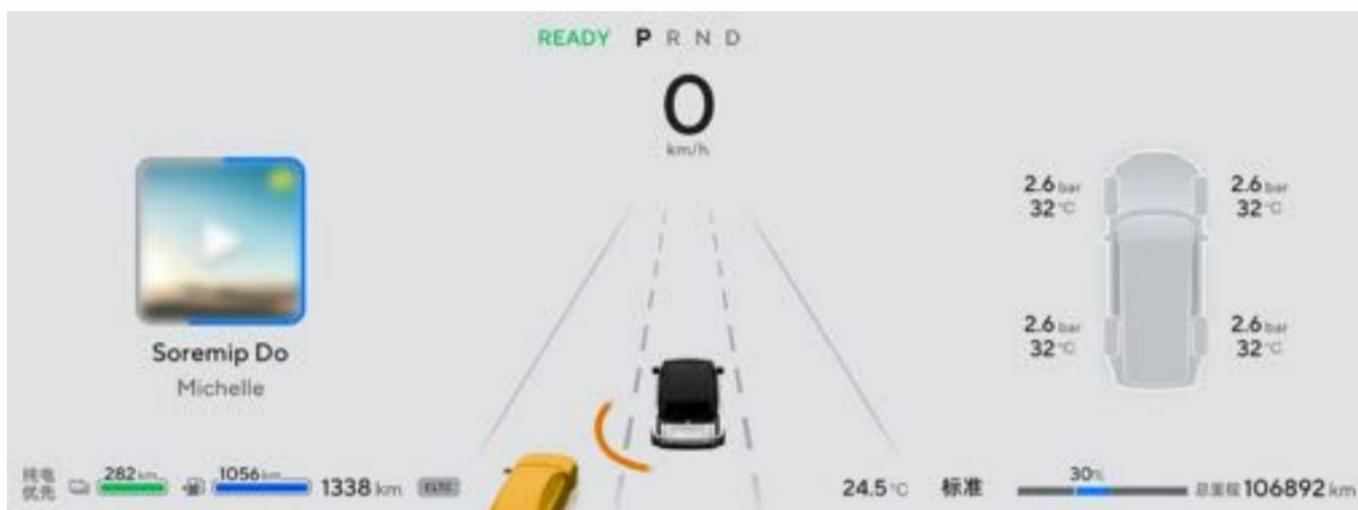
При обнаружении приближающегося автомобиля сбоку и сзади и открытии соответствующей боковой двери контрольная лампа на наружном зеркале заднего вида начнет быстро мигать, а желтый сектор на экране приборов станет красным.
