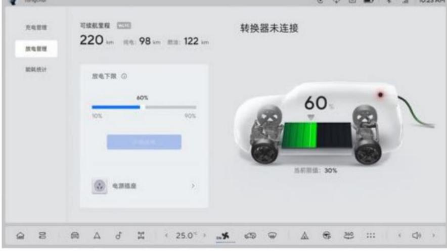
После установки преобразователя подвешивается значок «Запустить источник питания». Нажмите значок «Запустить источник питания», чтобы запустить внешний источник питания. Нижний предел разряда: аккумуляторная батарея разряжается до установленного нижнего предельного значения, а затем расширяется диапазон начинает поддерживать мощность аккумуляторной батареи на установленном нижнем предельном значении.
